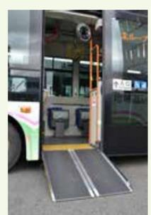
高齢者・障がい者の方々が安心して乗り降りできるように、床の高さが地上から約30センチメートルと低く、乗降口の床面は段差をなくしています。また、車椅子用のスロープをご用意しています。
